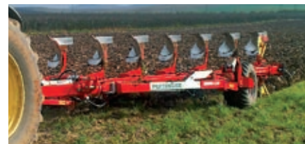
Polonesený 8-radič-ný pluh SERVO 6.50 PLUS NOVA s automatickým doťažovaním traktora Traction Control.
