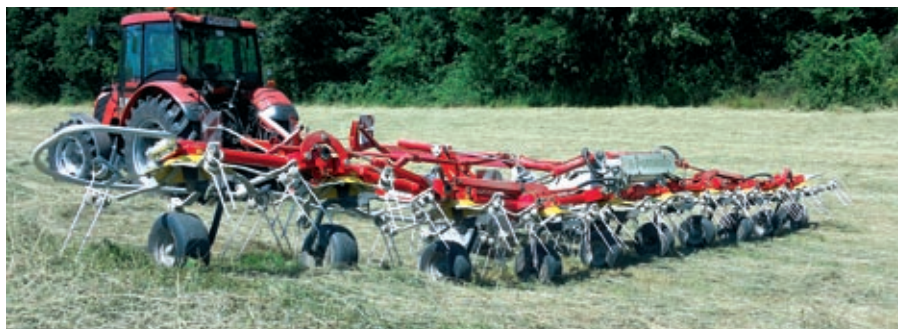
Obracač HIT 10.11 s pracovným záberom jedenásť metrov je v teréne stabilný a kvalitne obracia hmotu.
