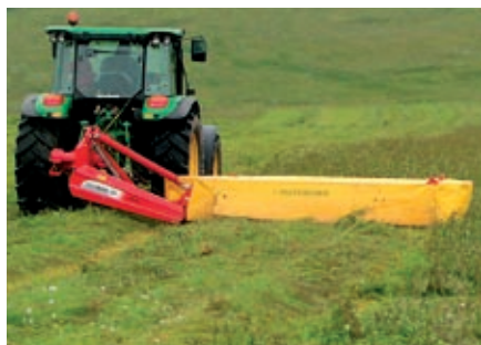
Diskový žací stroj NOVADISC 350 s pracovním záběrem 3,50 metru je charakteristický vysokou výkonností při nízké energetické náročnosti.
