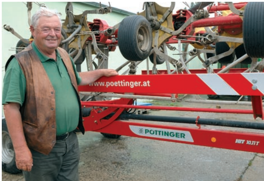
Maximálně spokojený je farmář Miroslav Hlaváček s obracečem HIT 10.11 T, který pořídili předminulou sezonu. S traktorem o výkonu motoru kolem 80 koní jsou s ním schopni za den kvalitně obrátit píci na 50 ha.
