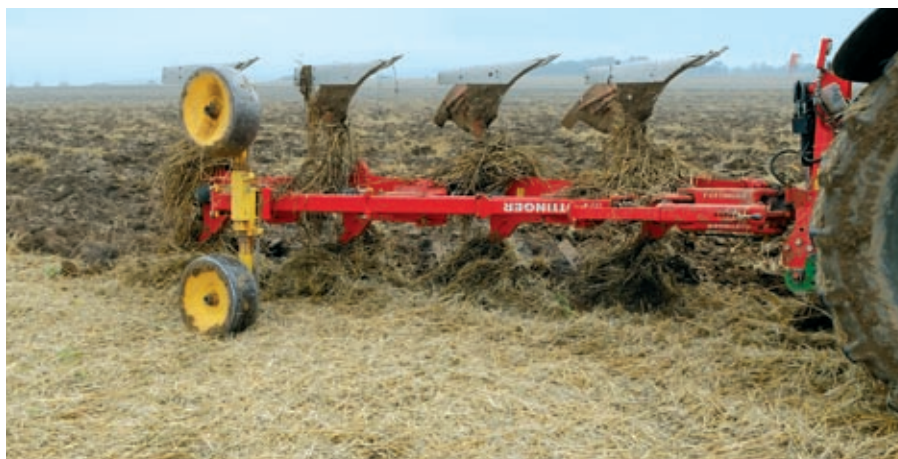
Nesený pluh s nonstop jištěním proti kamenům SERVO 25 NOVA. V extrémních podmínkách loni na podzim zpracovával pluh vlhké pozemky s velkým množstvím polehlé slámy.
