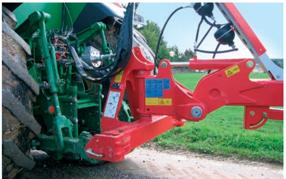
Dotěžování zadní nápravy traktoru systémem Traction Control.
