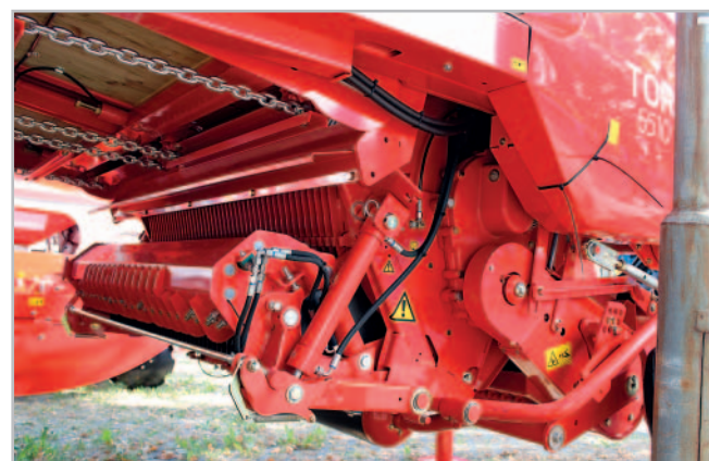
Nosník nožů lze nyní vyklopit stiskem jednoho tlačítka na levé straně vozu. Nože mohou být v provedení s jedno- nebo oboustranným ostrím. Podlahový dopravník je v přední části skloněn o 150 mm dolů Foto Petr Beneš
