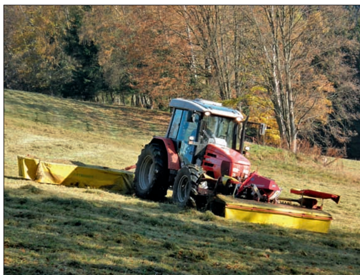
Same Silver 110 s diskovou žací kombinací firmy Pöttinger sklízí a udržuje 300 ha luk a pastvin v členitých a svažitéch podmínkách. Standardní traktor má pouze rozšířený rozchod kol, nápadná je nová kabina
