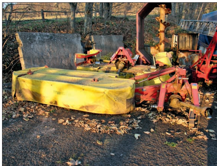
Diskové žací stroje Pöttinger na farmě : v popředí NovaDisc 265 s typickým bočním uchycením, v pozadí NovaCat 306 F s klasickým závěsem a sklopenými bočními kryty
