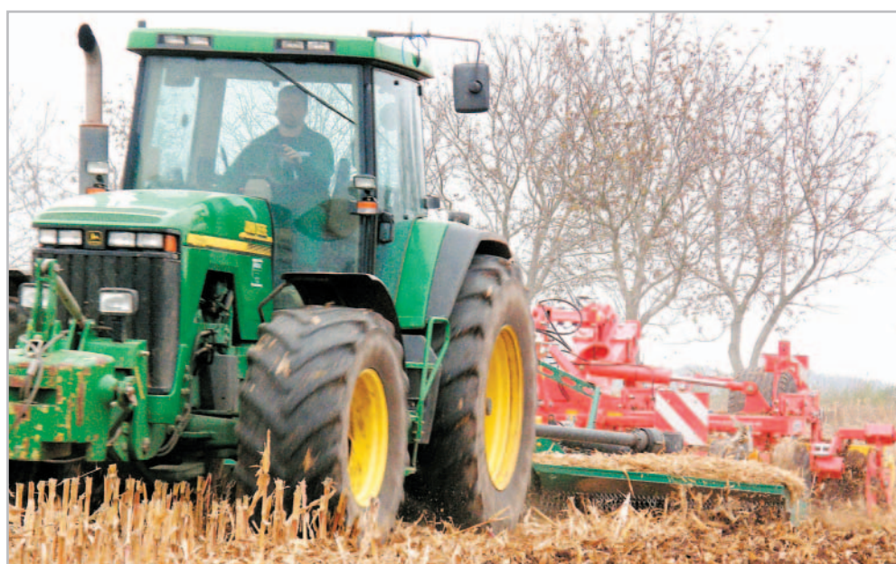
Bylo známo, že mulčovače Spearhead Star Cut jsou konstruovány speciálně jako polní a zvládnou i extrémní množství hmoty. Stroj neměl nejmenší sklony k ucpávání a také při rychlosti 12 km/h zvládal hmotu spolehlivě drtit a rovnoměrně rozložit. Foto Petr Beneš
