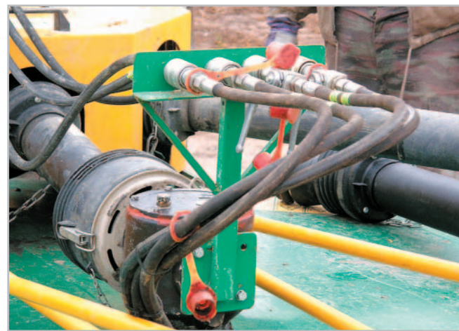
Hydraulické hadice podmítače nevedou až do traktoru, ale zapojí se do sady rychlospojek na mulčovači. Díky tomu může řidič z kabiny ovládat všechny hydraulické funkce Terradiscu tak, jak je zvyklý. Souprava obou strojů pak potřebuje celkem čtyři vnější hydraulické okruhy traktoru. Foto Petr Beneš
