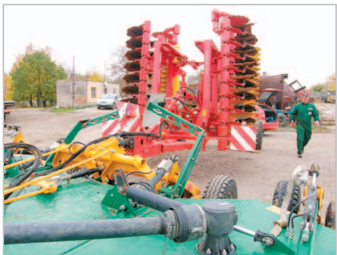
Není zvykem v našich podmínkách zapřahat dva závěsné stroje do soupravy s jedním traktorem. U soupravy podmítače Terradisc s mulčovačem Spearhead je zachována možnost nezávislého ovládání obou strojů z kabiny, což je důležité zvláště pro sklápění do transportní polohy a dále pak při otáčení na souvrátích. Foto Petr Beneš
