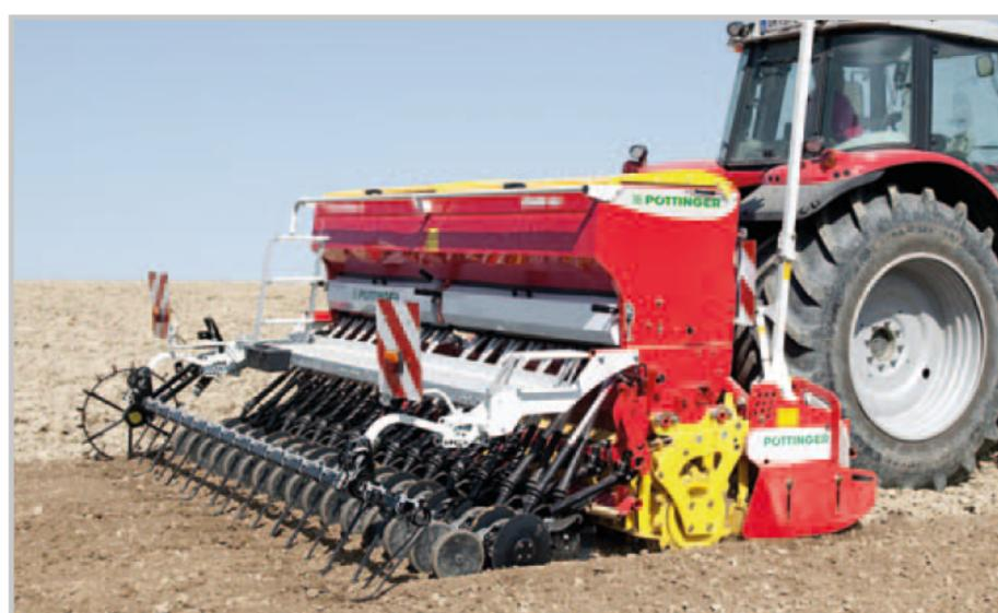
Vitasem je možné doplnit širokou volitelnou výbavou – botkami s různou roztečí řádků, znamenáky, kypřičí stop kol traktoru, elektrickým nastavením výsevku, vypínáním kolejových řádků, předznačením kolejových řádků, čechračem, centrálním nastavením přítlaku botek, opernými a utužovacími válečky
