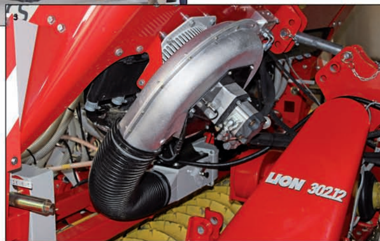
Tradiční přednost firmy Pöttinger – velký objem vzduchu pro šetrnou, ale výkonnou dopravu osiva – je u strojů AEROSEM zajištěna tímto hydraulicky poháněným ventilátorem. Ochranu před prachem a nečistotami poskytuje robustní kryt z hliníkových slitin
