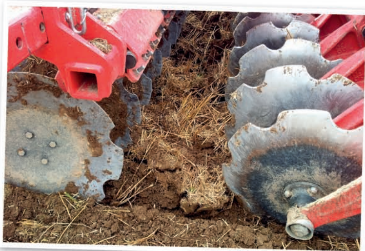
Drobení půdy prostřednictvím taliřů zabezpečuje dostatečnou předsetovou přípravu, nahrazující sekce pro aktivní přípravu před setím
