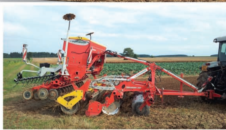
Oba stroje lze použít i samostatně. Na snímku taliřový podmítač Pöttinger Terradisc se zvedlým secím strojem bez nutnosti jeho odpojení, kdy navíc působí jako vhodné dotížení
