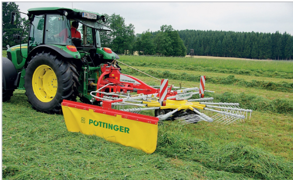
Shrnovač Top 422 je nenáročný. Údržbu nevyžaduje ani převodovka rotoru, která je utěsněna a dlouhodobě mazána tekutým mazivem
