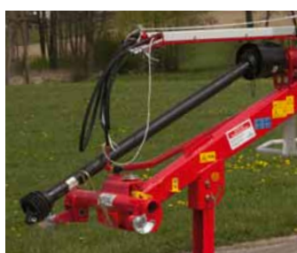
Praktické držáky vedení a hřídele jsou rovněž v základní výbavě stroje.
